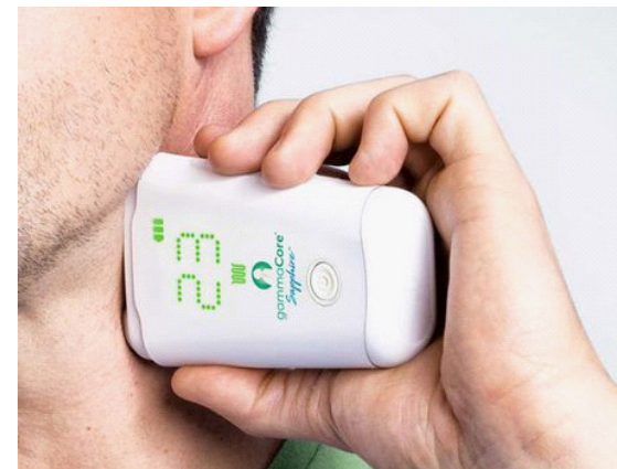
그림 9. 미주신경에 전기 자극을 줘 코로나 환자의 호흡곤란을 치료하는 전자약 감마코어, 조선일보 사이버카페 20.07.27
